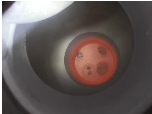
Abbildung 1: Agglomeration und Kanalbildung des Bettmaterials
