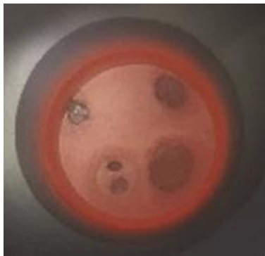
Abbildung 1: Glühendes Bettmaterial bei ca. 800°C
