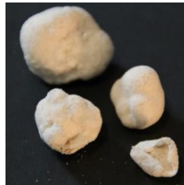
Abbildung 2: Agglomerate aus synthetischer Asche und SiO 2
