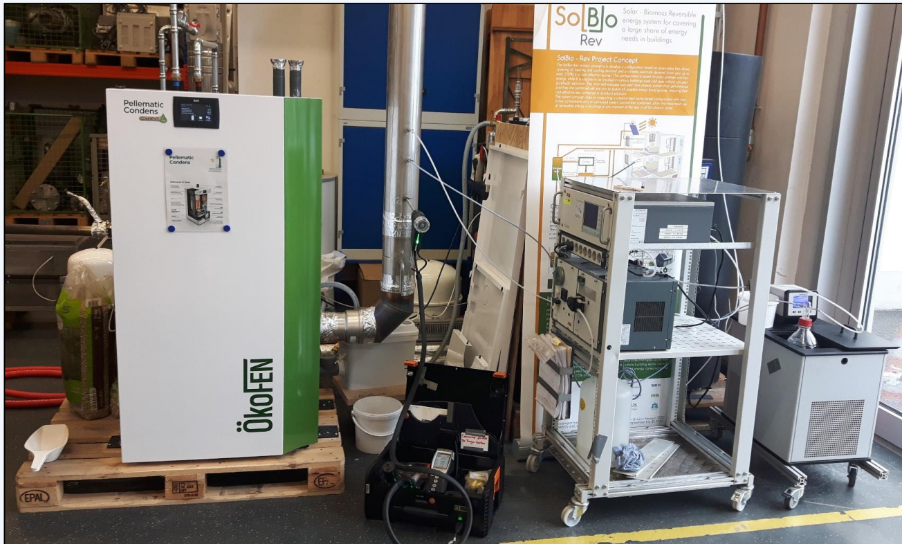
Versuchsaufbau des Pelletkessels mit Gas Analysator im Labor des Lehrstuhls
